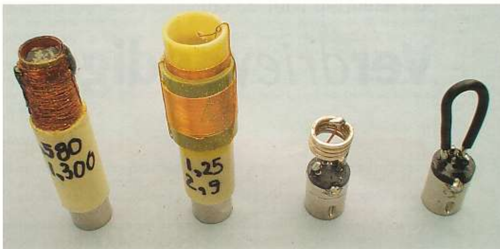
De vier bijzondere spoelen uit de serie, van links naar rechts. De eerste is de langegolfspoel met het korte ferrietstaafje erin. De spoel is gedeeltelijk in een stukje installatiebuis gedrukt. Voorzichtig, beschadig de isolatie niet. Nummer twee is de combinatie van de twee spoelen die over elkaar geschoven zijn. De laatste twee spoelen zijn die voor het VHF-bereik. Nummer drie met 4 windingen en nummer vier met slechts 1 winding voor het hoogste bereik.
